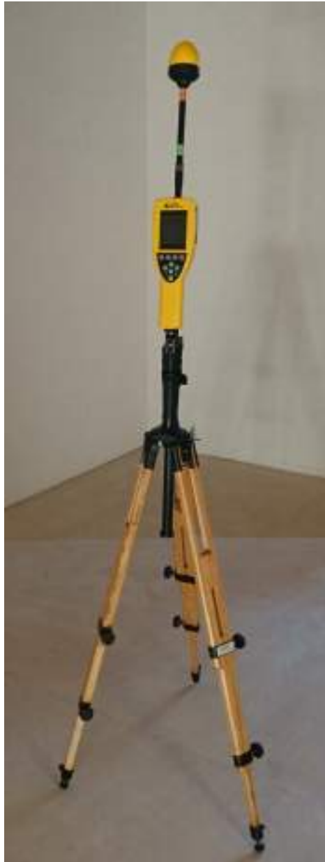
Figura 9. Medidor de la intensidad de campo modelo NARDA NBM-550 y antena omnidireccional NARDA EF-0391 para la medida del campo eléctrico (100 kHz – 3 GHz)
